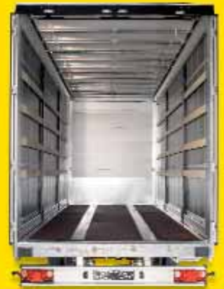
Großes Ladevolumen, Holzboden aus mehrfach verleimter Vielschichtplatte, staplerbefahrbar
