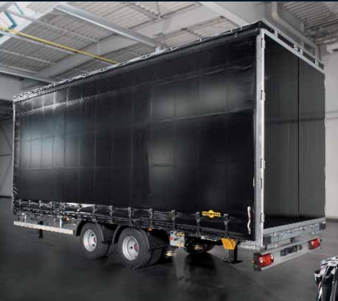
Großes Ladevolumen, Holzboden aus mehrfach verleimter Vielschichtplatte, staplerbefahrbar
