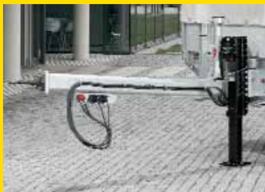
Über Spindel stufenlos höhenverstellbare Deichsel, zur optimalen Anpassung an das Zugfahrzeug
