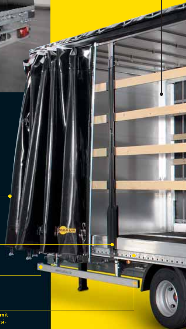
Stabiles Planengestell in den Ecken verstärkt
