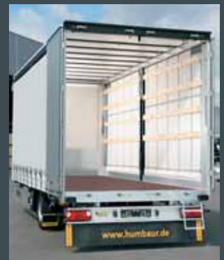
Abbildung oben: Schiebedach bei Curtainsideraufbau für Topbeladung
