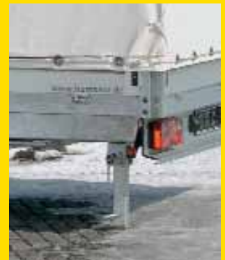
Serienmäßiger, massiver Stützfuß zur Heckabstützung zum Beladen ohne Zugfahrzeug
