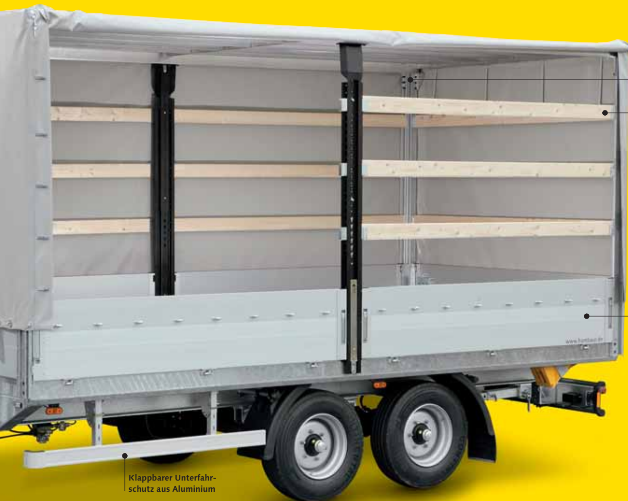
Einfaches Beladen auch von langen Ladegut, durch komplett zu öffnende Seite
